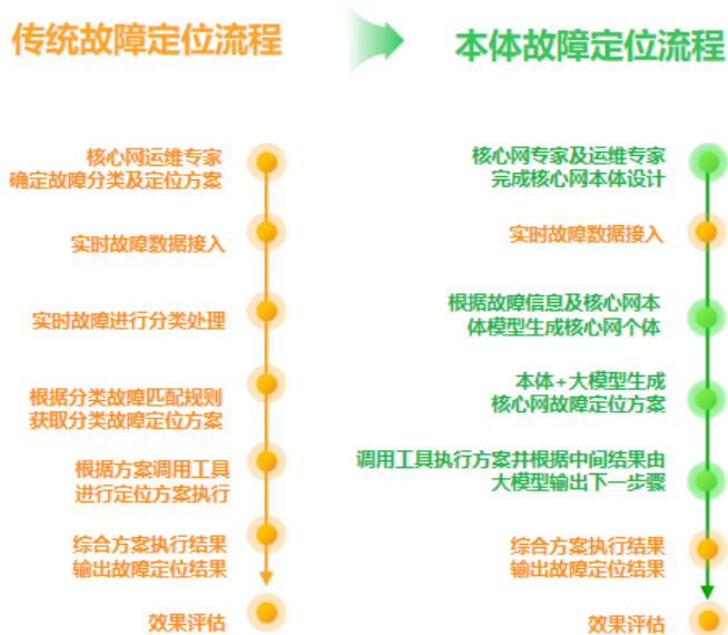
图 7-6 基于本体的故障定位流程优化
